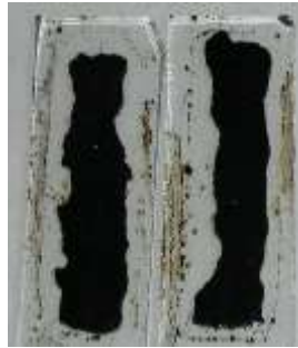
Рис. 1. Загальний вигляд скляних пластин після визначення показника зчеплення плівки вихідного бітуму марки БНД 60/90
