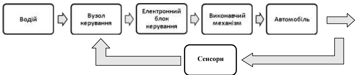
Рис. 1. Схема системи активного керування автомобілем.
