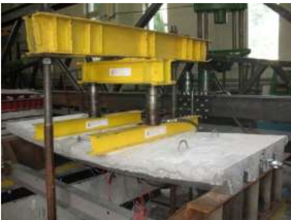
Рис. 5. Характер деформування зразків плит із анкеруванням у прольоті
