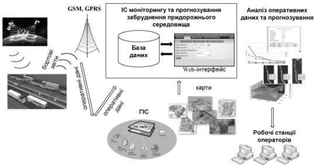
Рис. 6. Загальна принципова схема інформаційно-аналітичної системи моніторингу транспортних потоків
