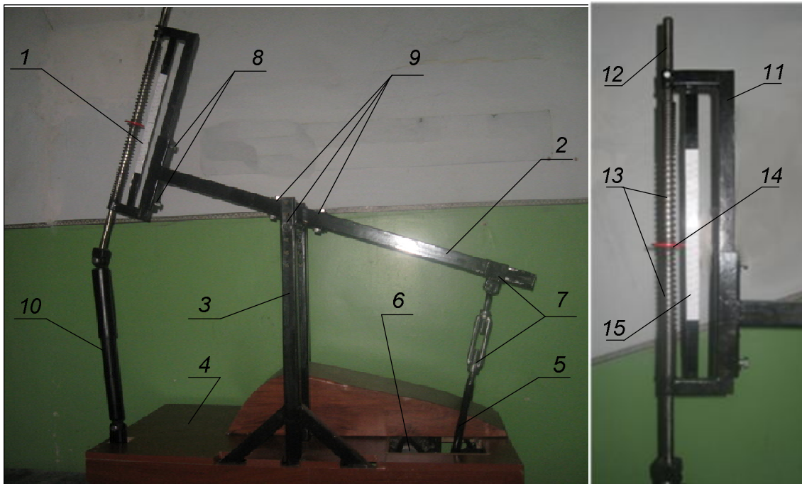
Рис. 1. Стенд для визначення деяких робочих характеристик амортизаторів підвіски легкового автомобіля:
