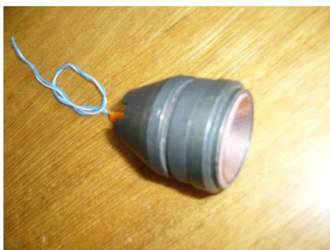
Рис. 1. Кумулятивный малогабаритный заряд с порошковой облицовкой.
