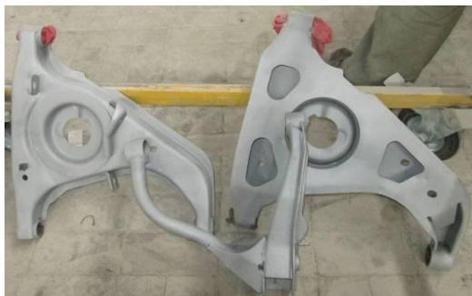
Рис. 11. Контрольні деталі після абразивоструменевої обробки
