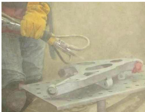
Рис. 10. Процес абразивоструменевої обробки контрольних деталей соплом збірної конструкції
