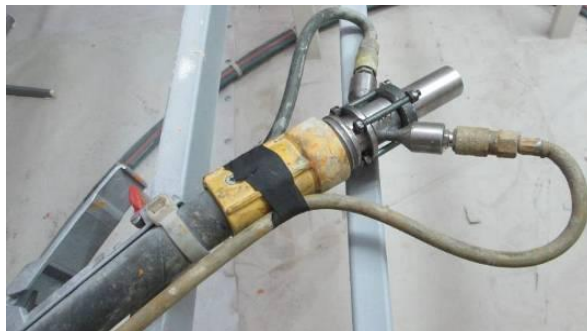
Рис. 4. Приєднане сопло нової конструкції, до рукава абразивоструменевої машини.
