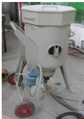
Рис. 5. Ємність в якій стиснене повітря змішується з абразивом
