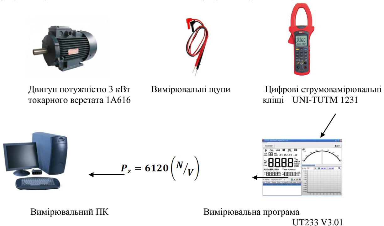
Рис. 1. Піктограма вимірювальної схеми непрямого визначення тангенціальної сили різання P_z
