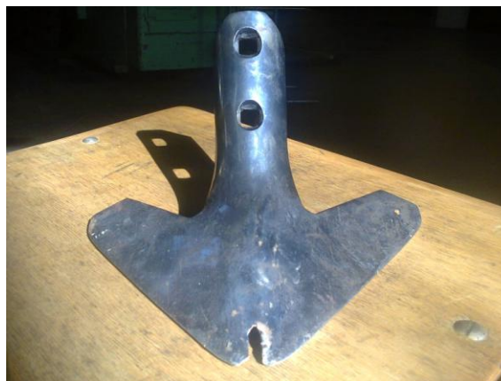
Рис. 2. Зношена стрільчаста лапа культиватора
