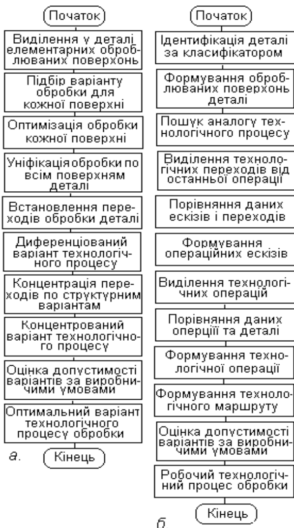
Рис. 1. Схема алгоритмів аналітичного (а) та аналогового (б) методів розробок технологічних процесів виготовлення деталей виробів
