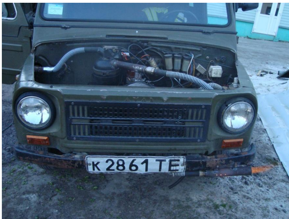
Рис. 4. Дослідний газогенераторний автомобіль ЛуАЗ 968М
