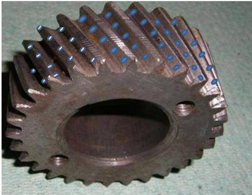
*Рис.14. Ведущее зубчатое колесо с гидродинамическими карманами реверсивной зубчатой цилиндрической передачи*
