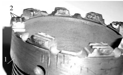
Рис. 4. Бурова коронки: БК–12 діаметром 93 мм, 1– корпус коронки, 2 – породоруйнівні елементи зі «славутича»
