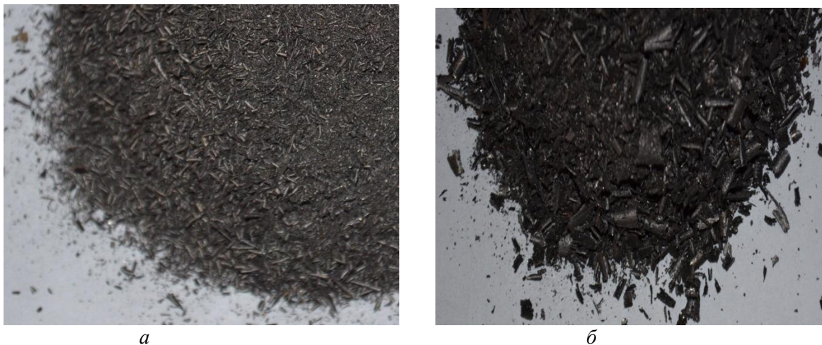
Рис.1. - Стружка сірого чавуну марки СЧ-18 отримана: а) при точінні; б) при свердлінні
