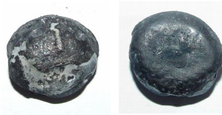
Рис. 4 – Матеріал отриманий в результаті метало термітної реакції композиту окалина - алюміній
