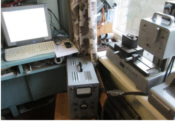
Рис. 7. Модернізований профілограф-профілометр моделі 202 заводу "Калібр"
