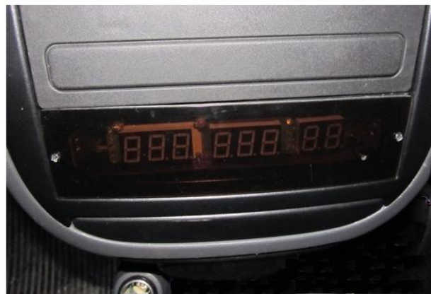
Рис.3. Расположение дополнительных измерительных приборов в конверсионном гибридном автомобиле
