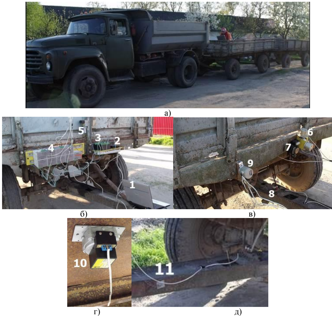
Рис. 1. Триланковий автопоїзд (а) з комплексом вимірювальної апаратури (б-д): 1 – інтегрований у вимірювальний комплекс автономний ПК з програмним забезпеченням на базі ноутбука; 2 - модем для дистанційної передачі даних; 3 – модуль ЦАП-ЦАП з гальванічною розв'язкою, лініями цифрового вводу-виводу; 4 – блоки живлення датчиків; 5, 7 - датчики лінійних переміщень; 6 – вібродатчики; 8 - датчик кутових переміщень; 9 – датчик швидкості; 10 – акселерометр; 11 – тензодатчик.
