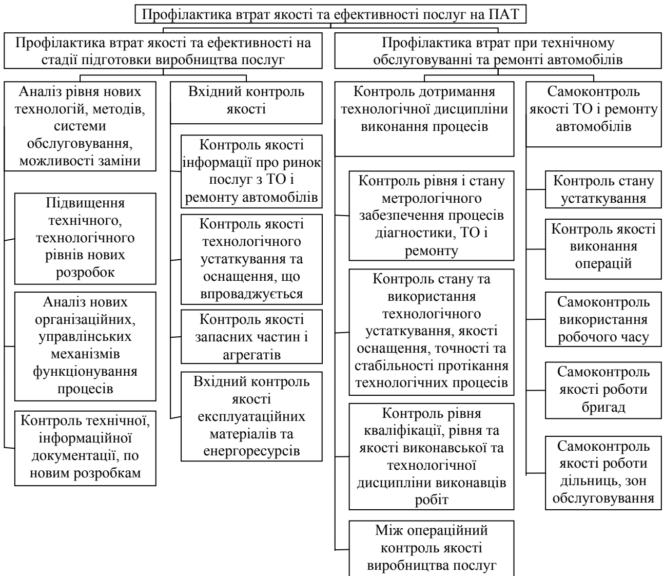
Рис. 2. Система профілактики втрат якості послуг і ефективності процесу обслуговування та ремонту автомобілів на підприємстві транспорту
