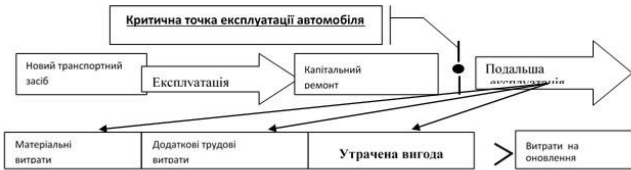
Рис. 2. Принципова схема залежності витрат з експлуатації транспортних засобів і витрат на їх оновлення поза зоною працездатності
