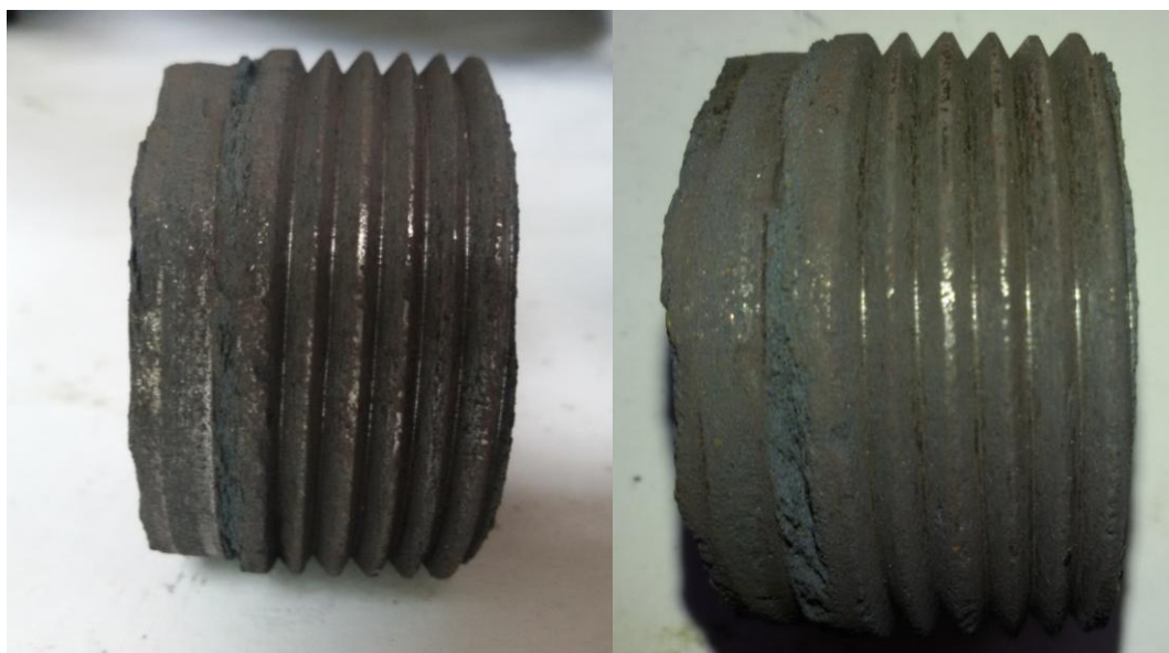
Рис.10. – Зразок № 3 після нарізування різі
