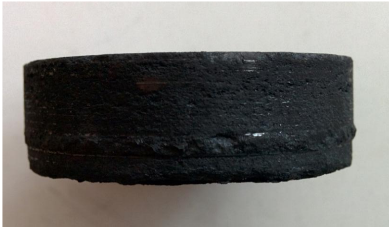
Рис.7. – Зразок № 2 після точіння циліндричної поверхні
