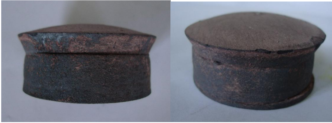
Рис.4. – Зразок № 1 після спікання
