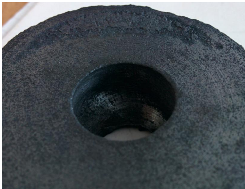
Рис.8. – Свердління отвору в зразку № 2
