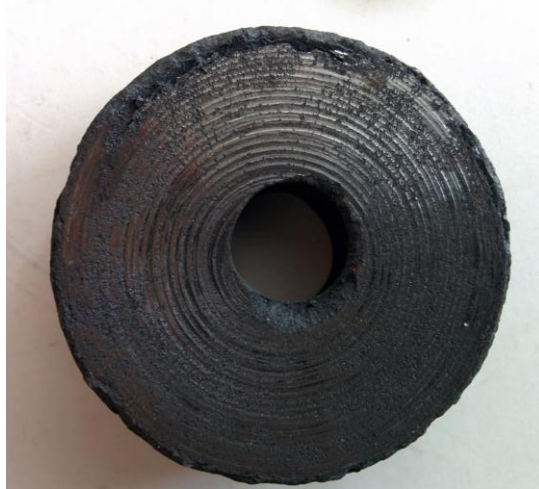
Рис.6. – Зразок №2 після точіння торця
