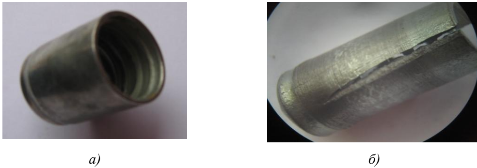
Рис. 1. Загальний вигляд фітинга: а - до операції обтискання, б - після операції обтискання (з тріщиною)
