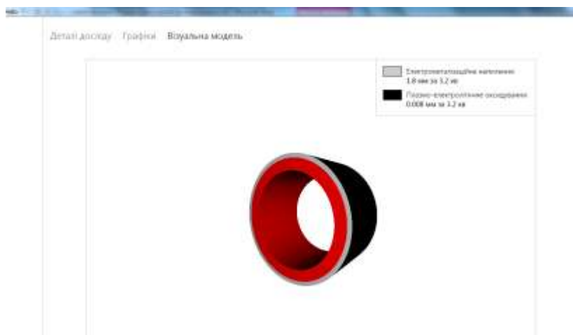
Рис. 3. – Зображення моделі деталі після наплення
