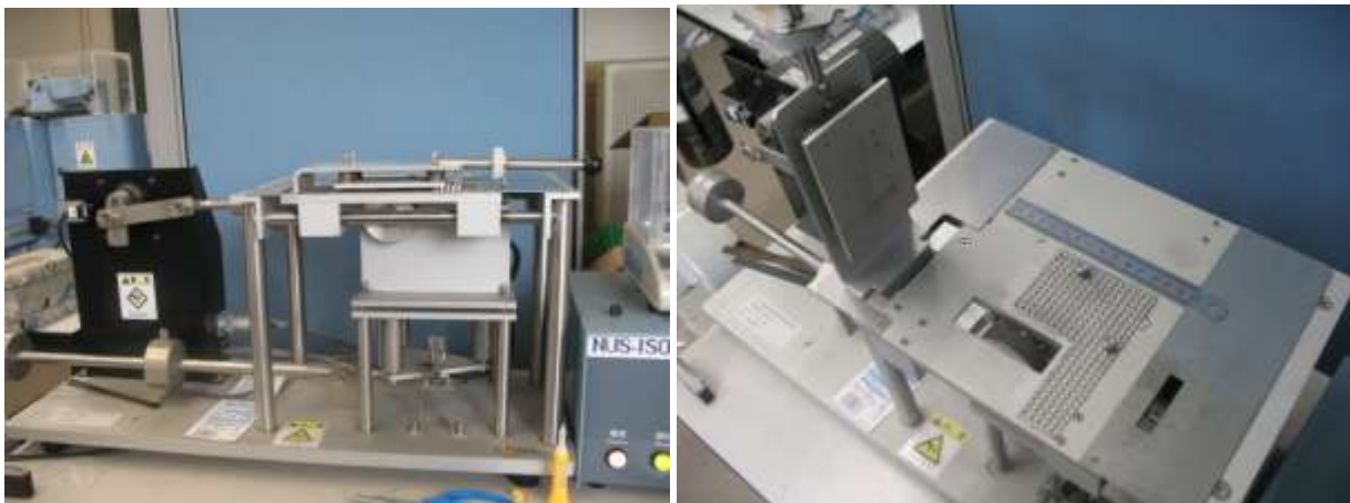
Рис. 3. - Установка для испытаний на абразивное изнашивание
