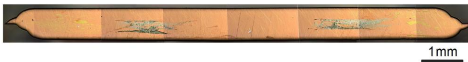
Рис. 4. - Поперечний переріз мідного диска з маркерами після 3 обертів КВТ
