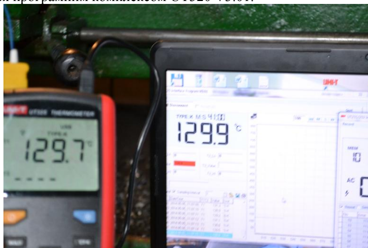
Рис. 1. Комплекс для вимірювання температури різання
