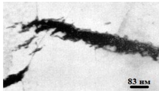
Рис. 2. Карбіди типу \text{Fe}_3\text{C} у приповерхневому шарі матеріалу ШХ15СГ + 5% \text{CaF}_2 після трибовипробувань, тонка фольга
