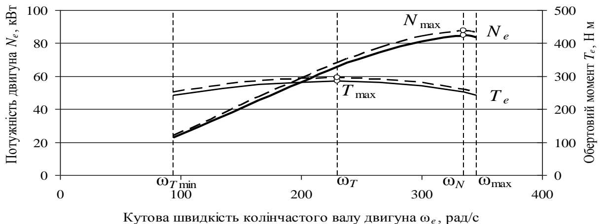
Рис. 1. Зовнішня швидкісна характеристика двигуна з розмірами циліндрів:
