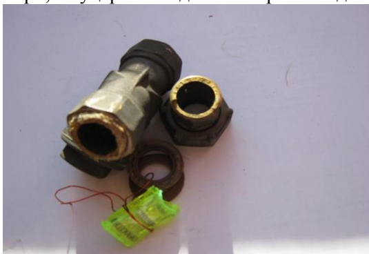
Рис. 1 Загальний вигляд елементів штуцера лічильника холодної води
