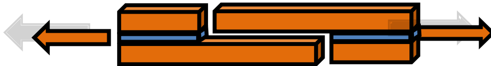
Рис.3.Схема дослідження адгезійної міцності на зсув
