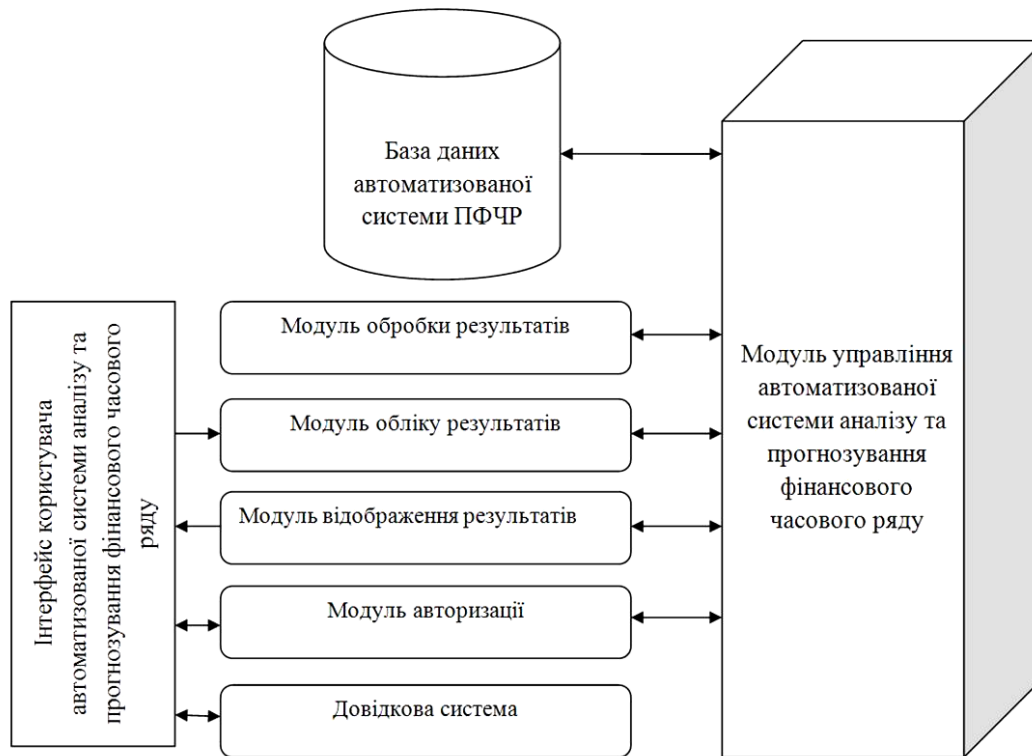
Рис. 2. Узагальнена структура програмних модулів автоматизованої системи аналізу та прогнозування фінансового часового ряду
