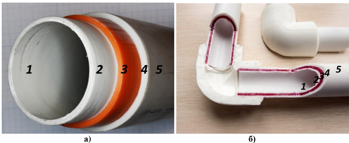
Рис. 2. Переріз тришарової поліпропіленової труби, армованої скловолокном та її розтрубного зварного з'єднання [12]: 1 – внутрішня поверхня; 2 – внутрішній шар монолітного поліпропілену; 3 – шар поліпропілену, наповненого скловолокном; 4 – зовнішній шар монолітного поліпропілену; 5 – зовнішня поверхня
