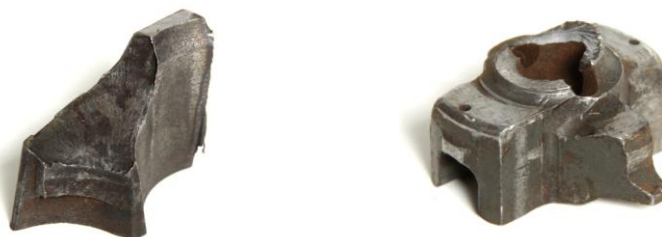
Рис. 1. Фрагменти зруйнованих елементів зарядного (пускового) механізму гармати.
