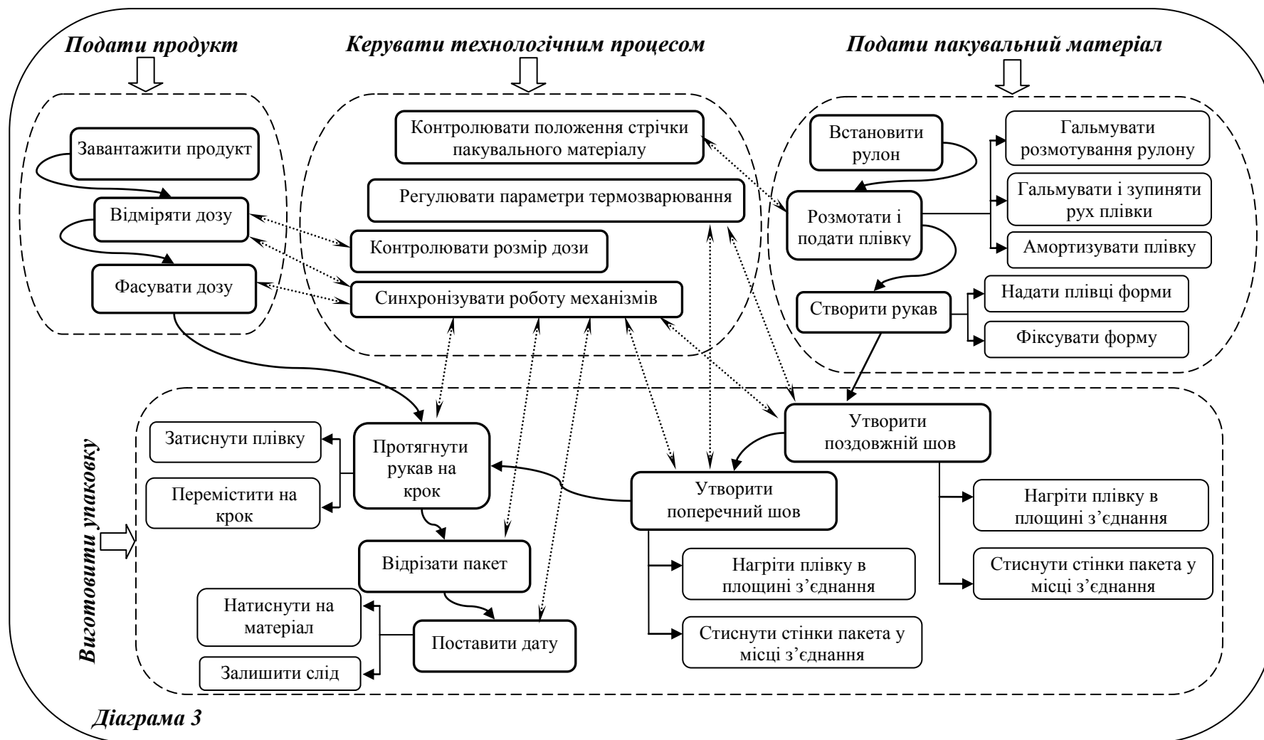
Рис. 2. SADT-модель технологічного процесу пакування сипкої продукції в полімерні пакети (діаграма 3)
