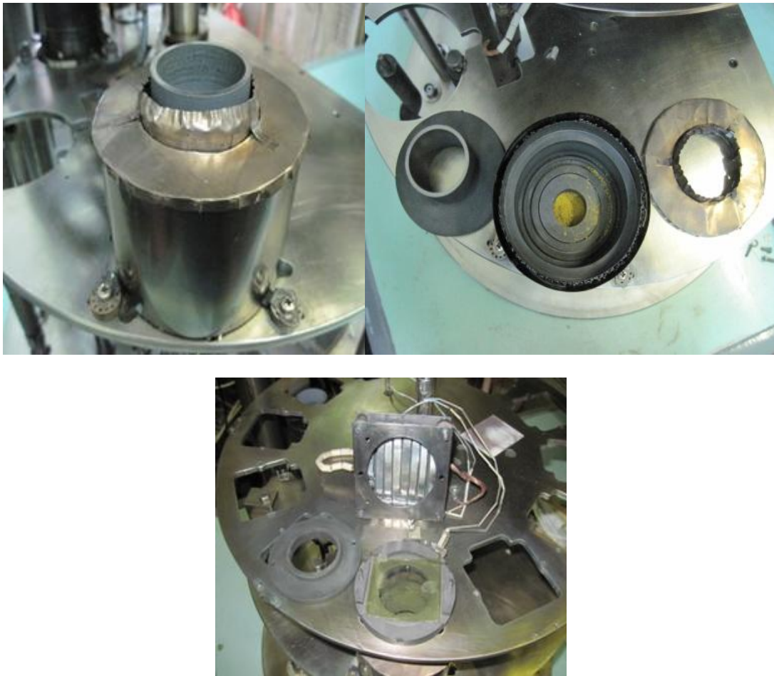
Рис. 3. Технологічна оснастка для нанесення шарів сульфїду і телуриду кадмію в квазізамкненому об'ємі
