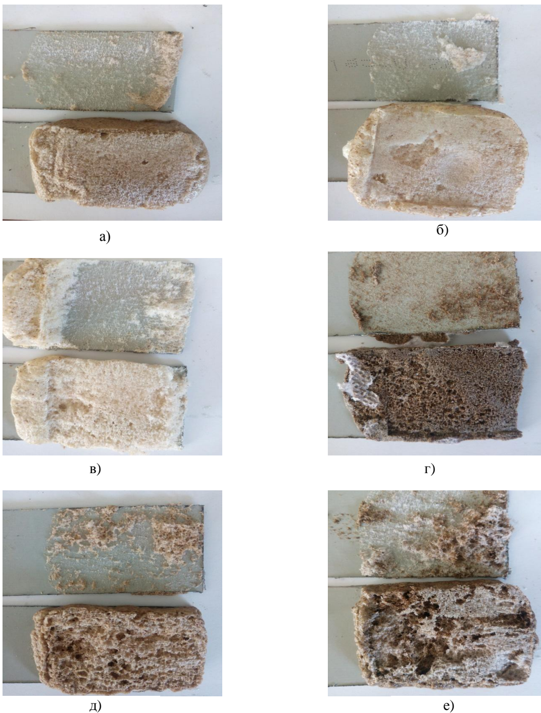
Рис. 4. Зруйновані зразки: а – ясен 200, б – ясен 560, в – хвоя 560, г – дуб 200, д – хвоя 200, е – дуб 560
