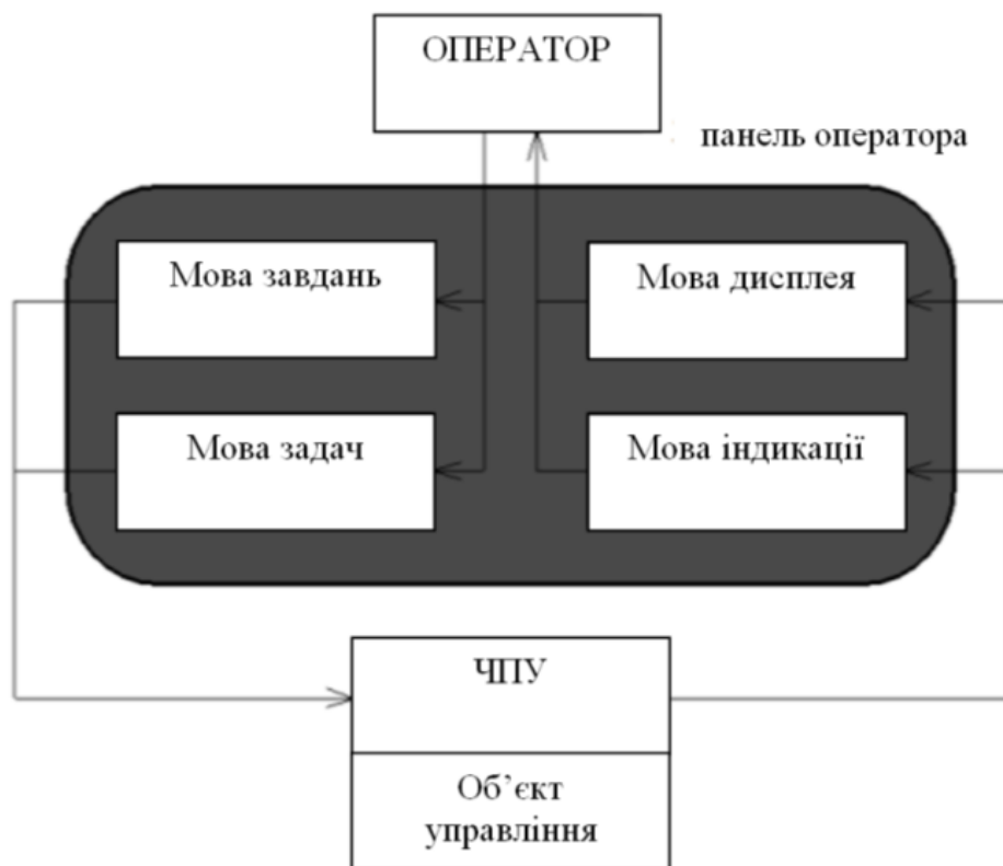
Рис. 1. Зв'язок оператора з пристроєм ЧПУ
