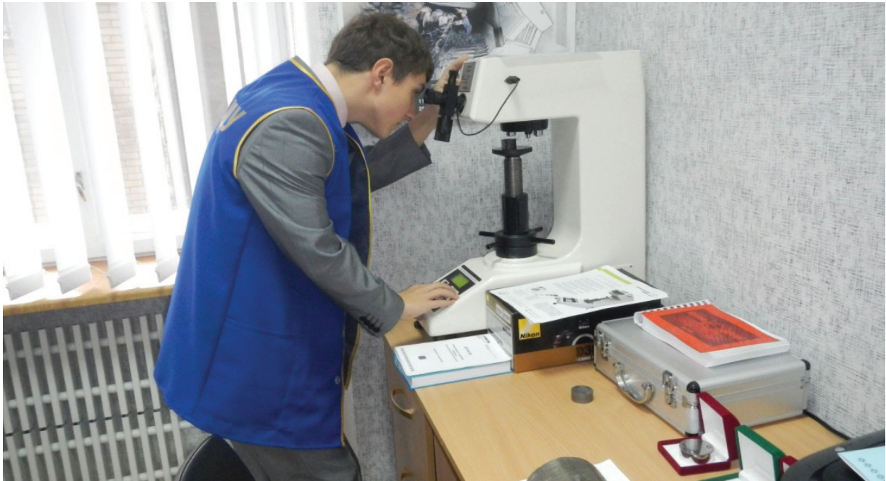
Рис. 3. Исследование образца наплавленного покрытия с помощью твердомера UIT-NV-50S
