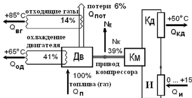
Рис. 1 – Схема теплонасосной установки с газовым двигателем-генератором
