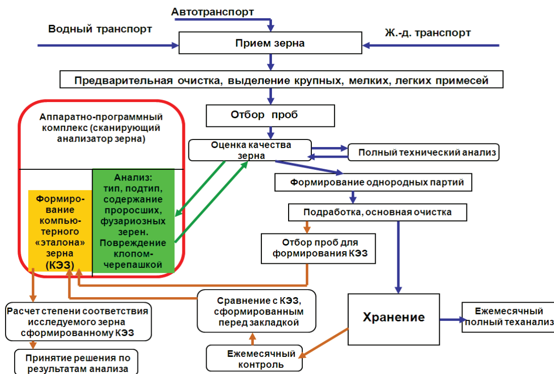
Рис. 4 – Схема контроля качества и состояния зерна при формировании и хранении партий с применением сканирующего анализатора зерна
