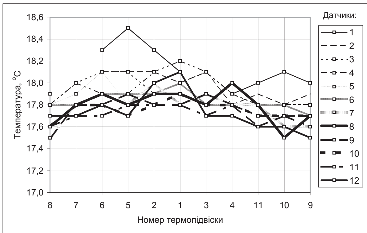
Рис. 2 – Коливання температури в різних шарах зерна в об'ємі силосу 21.10.2009 р.
