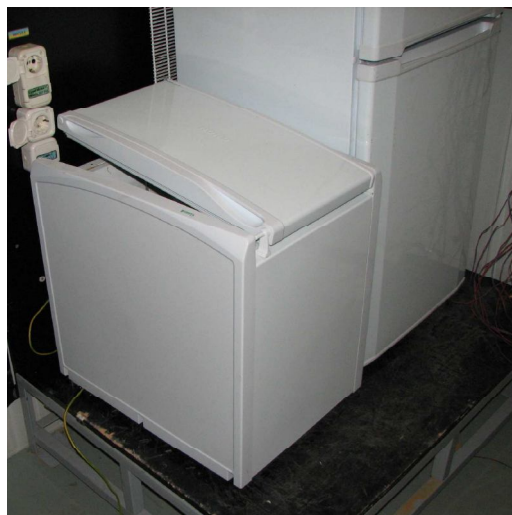
Рис. 1 – Загальний вигляд автономного термоізованого блока для гарячої води
