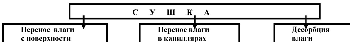
Рис. 2 – Структурная схема процессов при сушке
