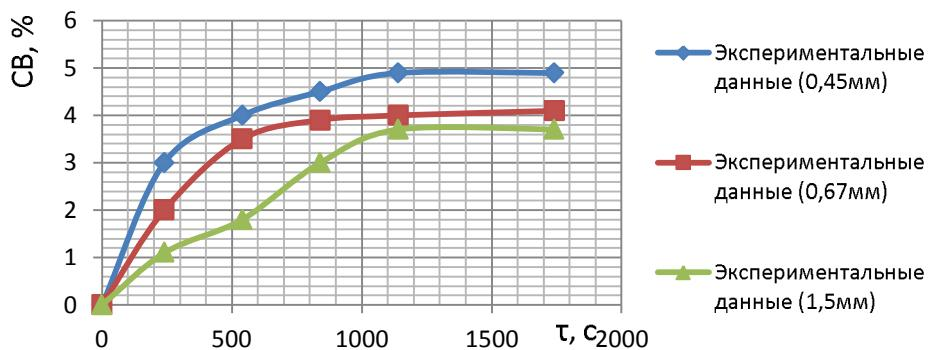
**Рис. 2 – График по извлечению экстрактивных веществ из кофейных зерен при различной дисперсности сырья**
