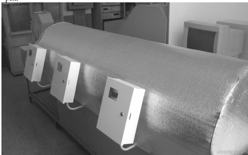
Рис. 5 – Действующий экспериментальный образец микроволновой ленточной сушилки разработанной и построенной в ОНАПТ
