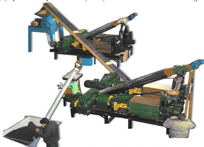
Рис. 3 – Линия производства рапсового масла М8-МКИ (рапс)
