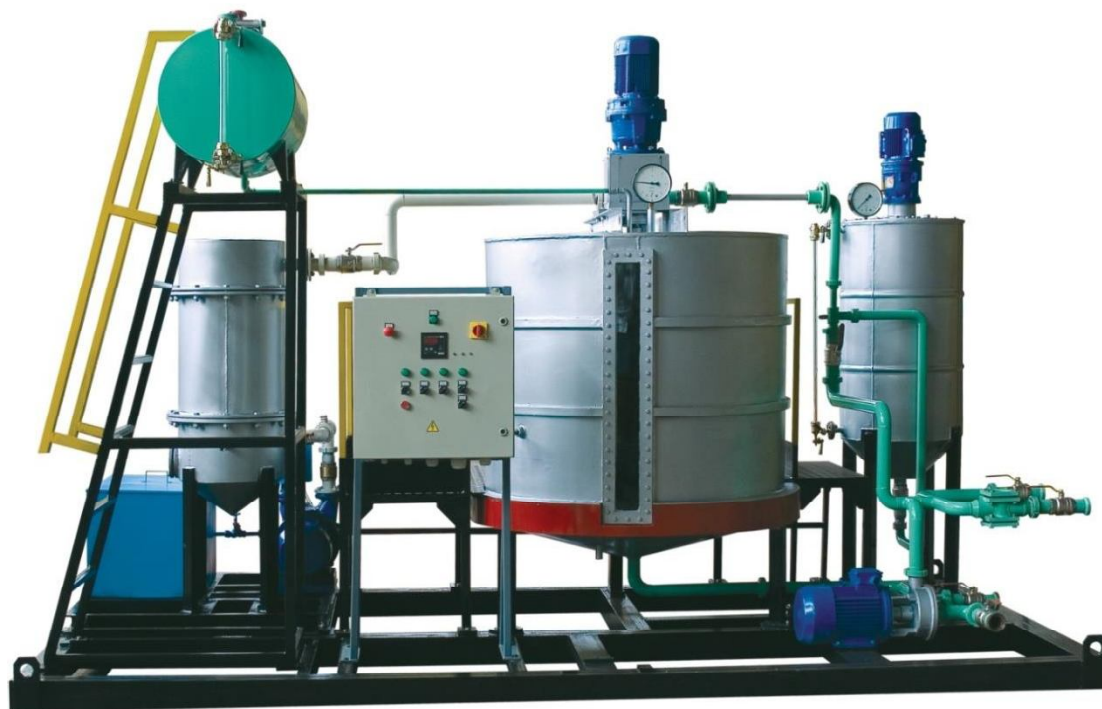
Рис. 6 – Пилотная установка для производства биодизеля марки М8-КПБ-01
