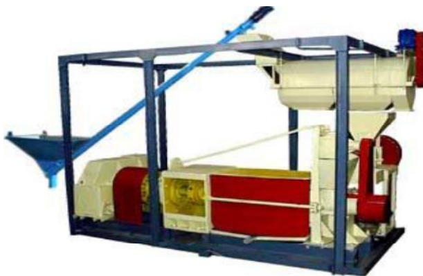
Рис. 2 – Комплект оборудования для производства растительных масел М8-МКИ
