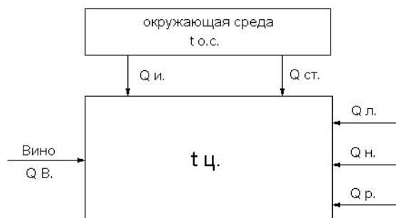
Рис. 7 – Схема тепловых потоков цеха розлива.
