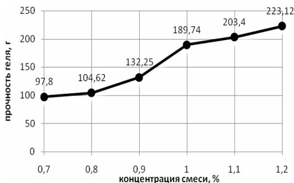
Рис. 3 – Зависимость прочности гелей от концентрации к-каррагенан/ксантан
