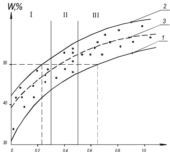
1, 2 – розрахункові криві при різних вологостях і вмісті шкірочки, насіння, залишків гребенів; 3 – експериментальна залежність; I, II, III – зони важкого, нормального і полегшеного режимів пресування.
