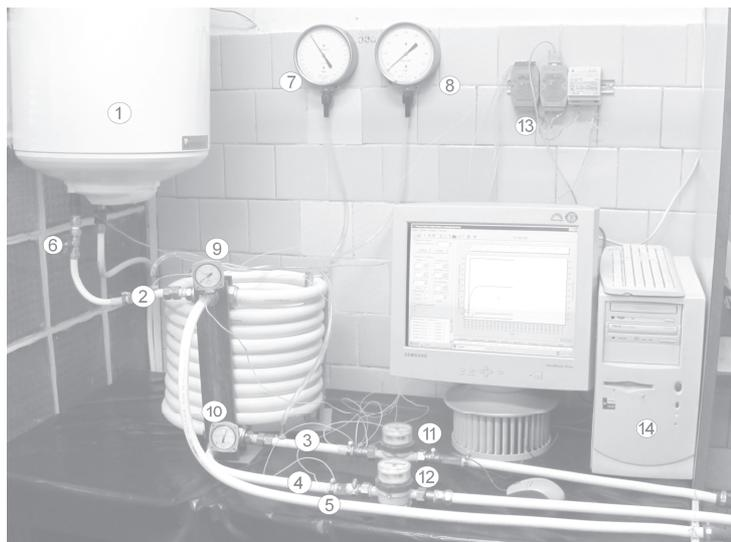
**Рис. 2 – Лабораторний стенд для дослідження експериментальних зразків теплообмінників**
